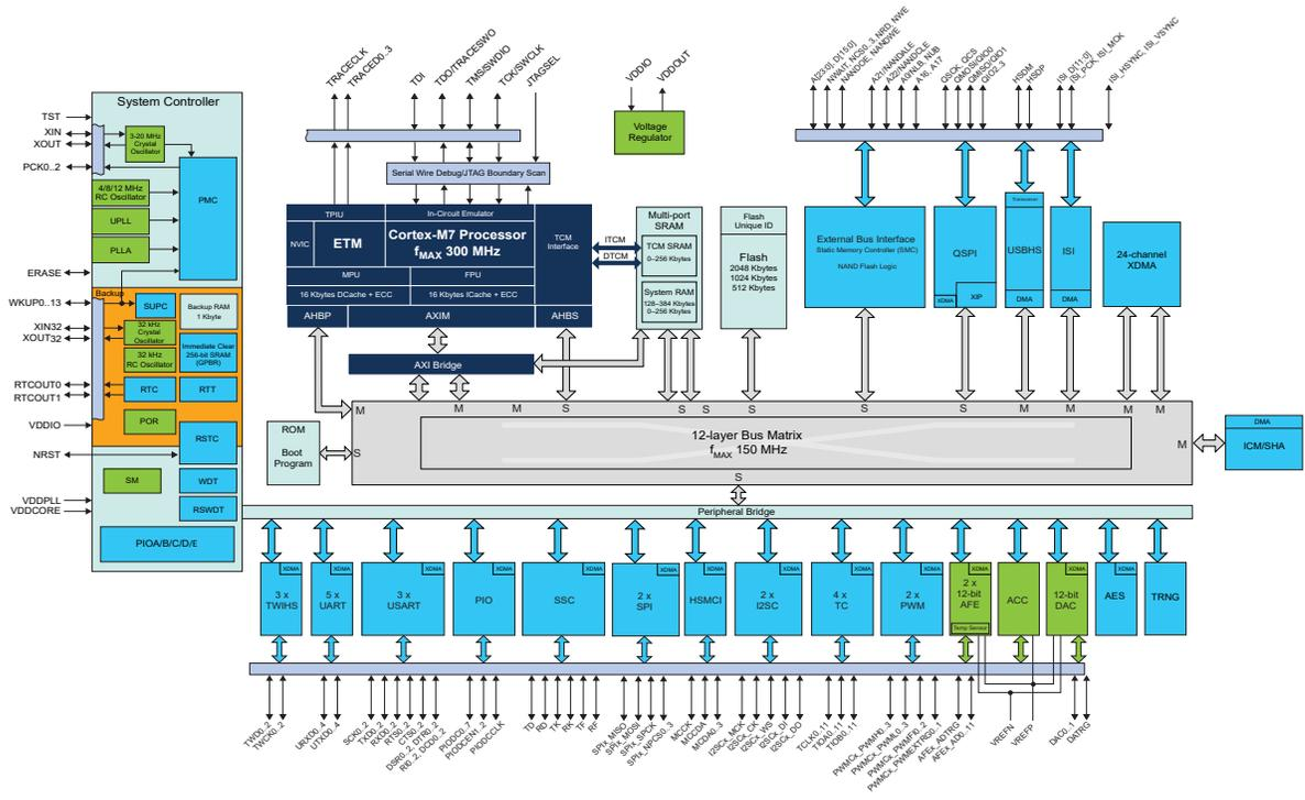
Figure 3-2. SAM E70 144-pin Block Diagram
